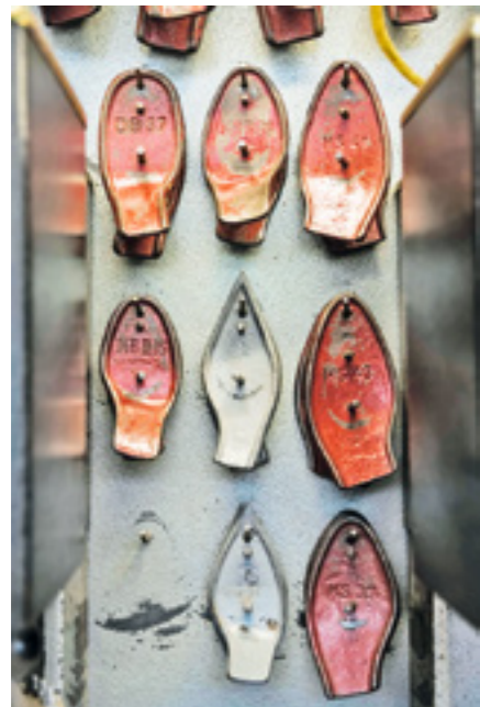
6 – Sohle Auf einer Metallunterlage in Form des Schuhs (Bild l. und o.) werden die Lagen zusammengepresst.
