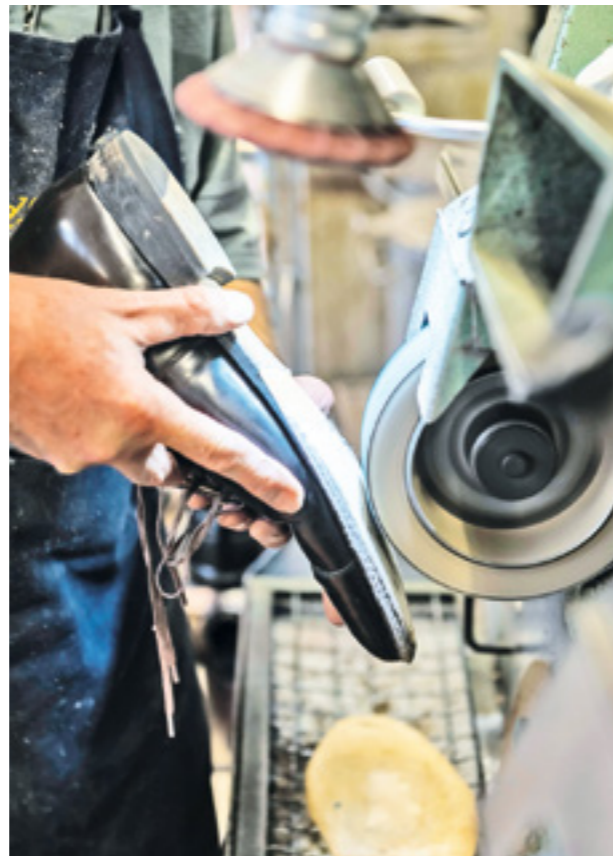
8 – Schleifen Ein Arbeiter gleicht die Unebenheiten an der Sohle aus.
