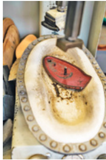
6 – Sohle Auf einer Metallunterlage in Form des Schuhs (Bild l. und o.) werden die Lagen zusammengepresst.
