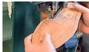
Die Sohle braucht eine spezielle Nähmaschine.
